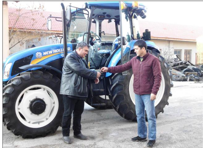
Дизеловият двигател е с мощност 110 к.с., с турбокомпресор и интерколер. Механичната трансмисия е синхронизирана, с електрохидравличен реверс, осигуряващ 12 предни и 12 задни предавки. Кабината е оборудвана луксозно – радио и MP3;
